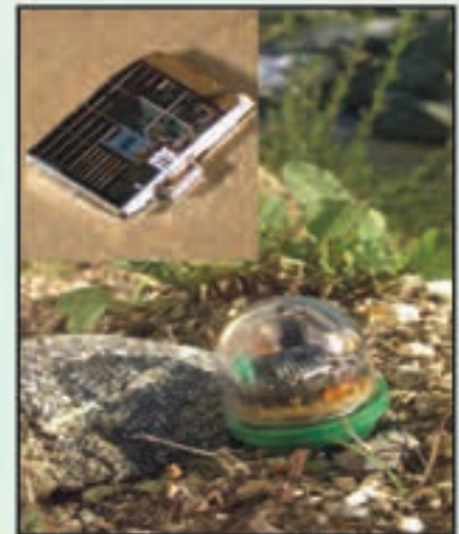
شكل (٤): الشكل الخارجي لـ MEMS المستخدمة في الغبار الذكي.
